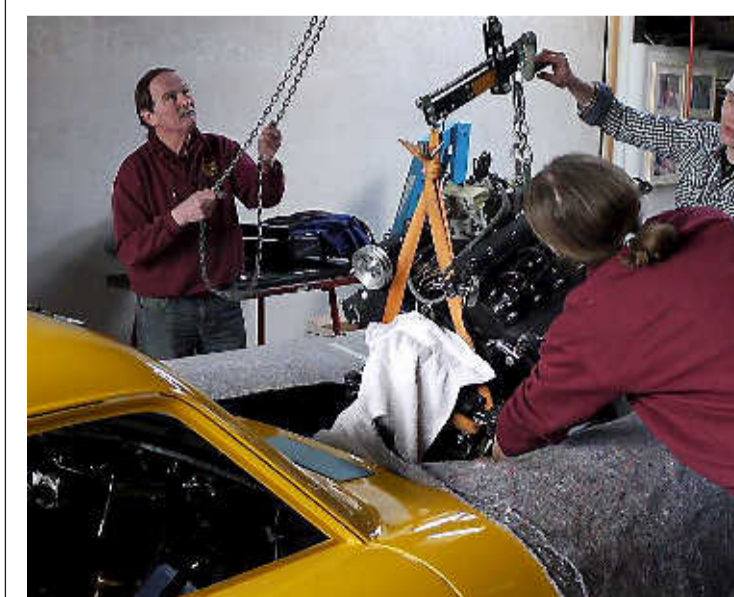
Vader Jacques coördineert de plaatsing van de motor.
